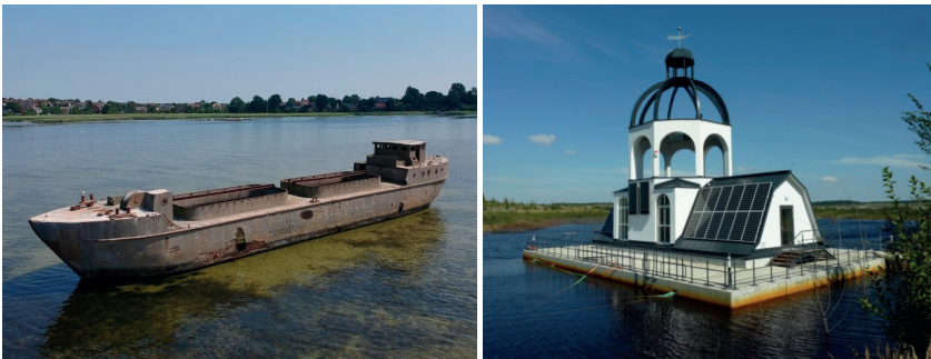
Abb. 1: Links: Betonschiffswrack von Redentin in der Wismarer Bucht, Länge ~ 40,5 m (Foto: A. Micheel); rechts: Schwimmendes Kunstobjekt „Vineta“ im Störmthaler See bei Leipzig, Stahlbetonponton: 15 m x 20 m [36] (Foto: Clement Germany GmbH)
