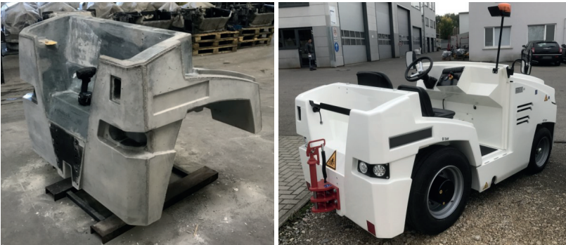
Abb. 3: Links: Rohguss - Beton-Karosseriekomponente für einen Schlepper; rechts: Schlepper mit Beton-Karosseriekomponente [41] (Fotos: M. Tenwinkel)
